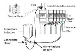
**Nota:** Nel caso in cui si utilizzasse il dispositivo in un sistema con impianto fotovoltaico, per monitorare correttamente l'energia consumata il clamp andrà posizionato a valle dell'interruttore generale.
